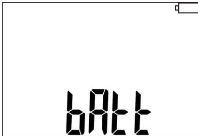
Baterías casi descargadas, todas las mediciones están bloqueadas. El medidor se apaga automáticamente después de 5 s.
