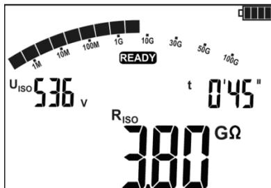
Después de la finalización o interrupción de la medición se puede leer el resultado. Se mostrarán los resultados de todas las mediciones hechas (también en caso de interrupción de la medición p. ej. después de 60 s). Si el medidor ha pasado a la pantalla de espera, se puede volver a ver el resultado de la medición pulsando **ENTER**.
